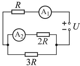
**Решение (первый способ).** Найдем, как связаны токи  $I_1$  и  $I_2$  через амперметры  $A_1$  и  $A_2$ . Учтём, что через сопротивление  $2R$  течет ток  $I_2$ , а через сопротивление  $3R$  — ток  $I_1 - I_2$ , а напряжения на этих сопротивлениях, равные  $I_2 \cdot 2R$  и  $(I_1 - I_2) \cdot 3R$ , должны быть одинаковыми:  $I_2 \cdot 2R = (I_1 - I_2) \cdot 3R$ . Отсюда  $I_2 = 0,6I_1$ .
