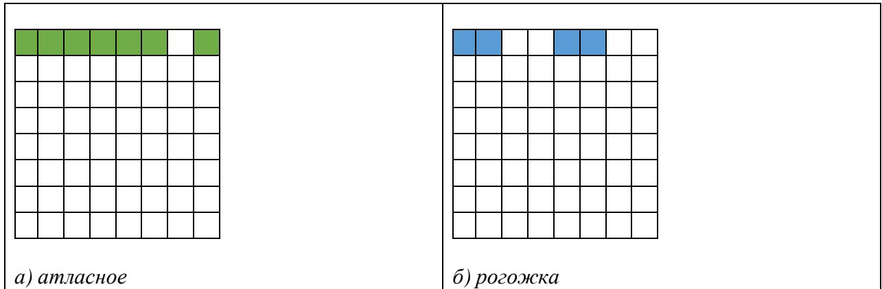
*11. Объясните почему ткани атласного переплетения, схему которого вы заполняли в вопросе 10, отличаются повышенной стойкостью кстиранию, высокой прочностью, малым коэффициентом трения (хорошо скользят, имеют ровную и гладкую поверхность)?*
