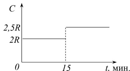
По истечении первых пятнадцати минут процесс становится изобарическим. Следовательно, при этом  $C = \frac{5}{2}R$ .
