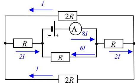
Оно равно  $6IR$  и, следовательно, через данный резистор идет ток  $6I$ . Тогда по ветви, содержащей источник и амперметр, идет ток  $8I$ , причем  $U = 6IR$ , и окончательно,  $I_A = \frac{4U}{3R} = 2$  мА.
