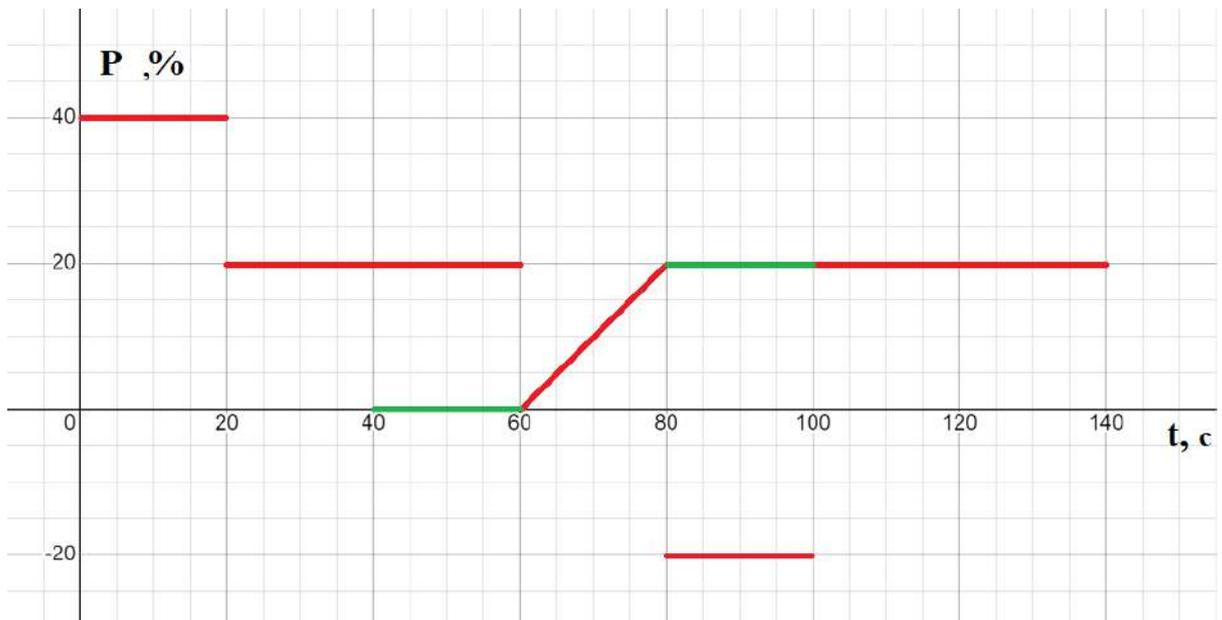
1) Разворот вокруг колеса происходит, когда один из моторов выключен, а второй работает. По графикам видно, что разворот вокруг колеса В происходит на промежутке от 40 с до 60 с. То есть, в ответ мы запишем: 40,60.
