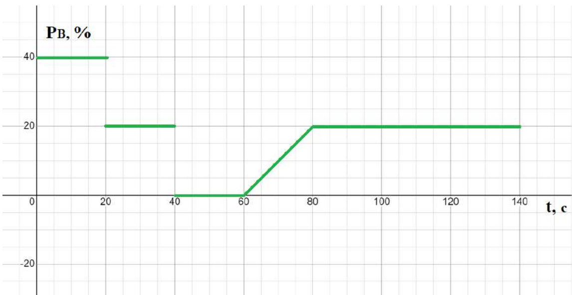
Рисунок 3. График показаний энкодера правого мотора В.
